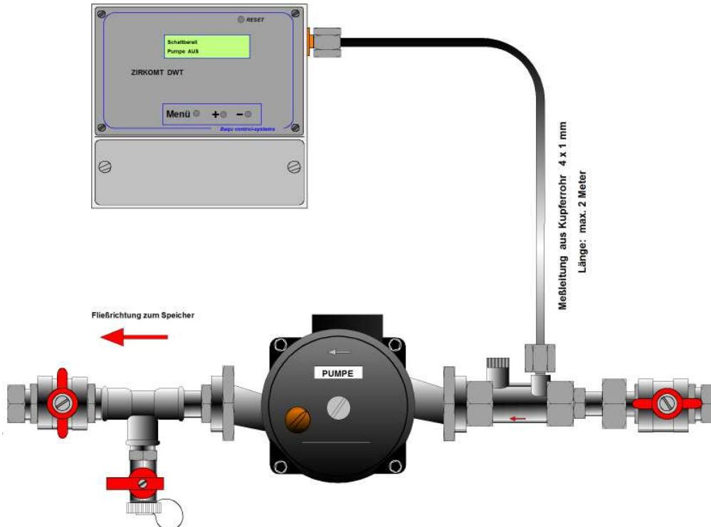
ZIRKOMAT DWT mit Anschlußbaugruppe und Pumpe
